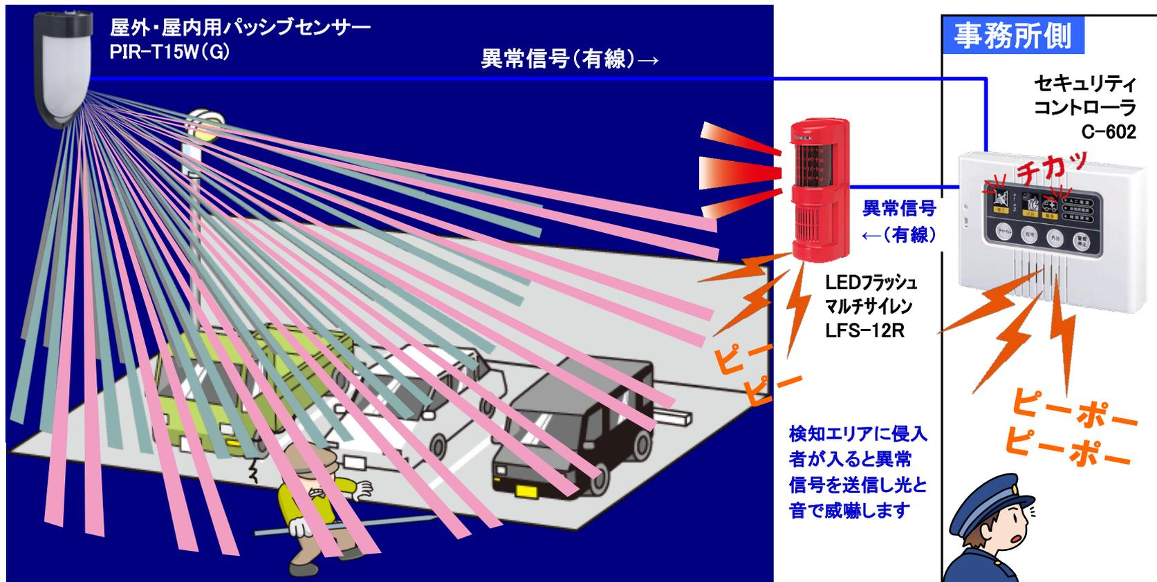
**センサーで侵入者を検知し、音と光で威嚇します**
